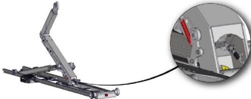
El interruptor de brazo retraído supervisa los ganchos de bloqueo mecánico se encuentren en la posición abierta durante la operación de carga / descarga
