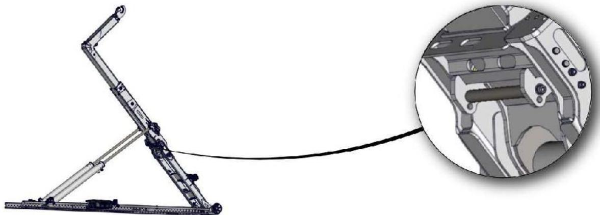
Bastidor trasero / columna central de bloqueo y liberación mecánica
