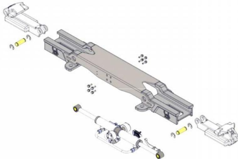
Sistema de cierre del contenedor hidráulico reversible atornillado: mordazas internas DIN 30722, mordazas externas (AFNOR, SWNSK, norma CHMN), con interruptor de control mecánico
