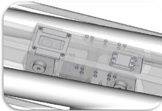
Protectores adicionales para ayudar en el movimiento del contenedor cargado hacia y desde el remolque
